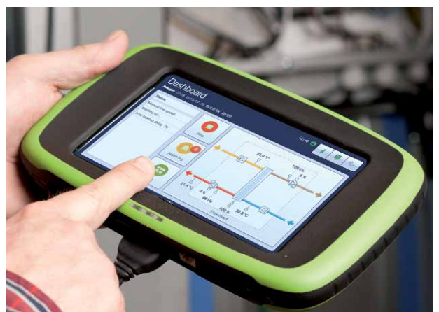
Programowanie lub kontrolowanie pracy central GOLD odbywa się za pomocą programatora z prostym, intuicyjnym menu.
